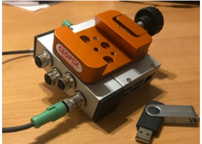
Der fertig montierte StromPi mit Anschlüssen und Prismenschiene
